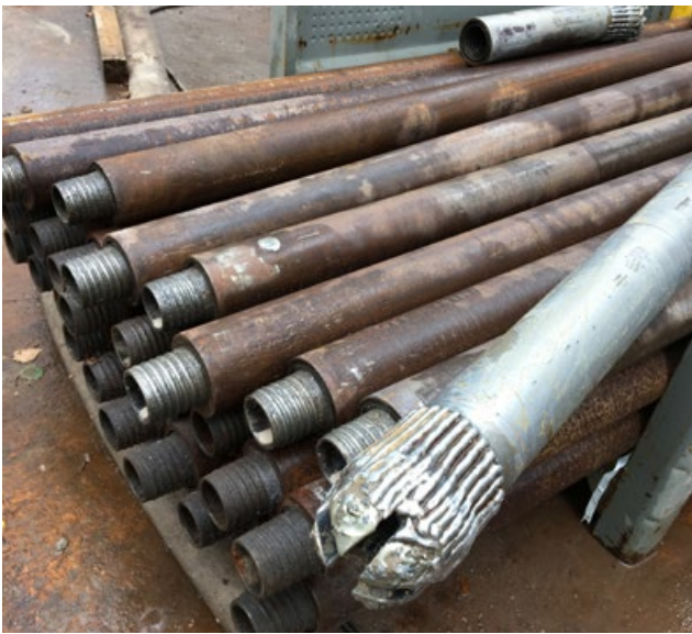
Abb. 4 – Doppelwandgestänge für Injektionsbohrungen
